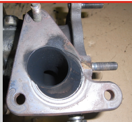
Dichtung falsch angelegt => Geräusche und Leistungsverlust
