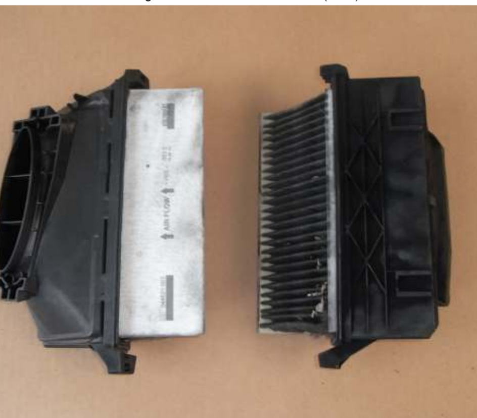
Abbildung: verschmutzte Luftfilter E350CDI (W212)
